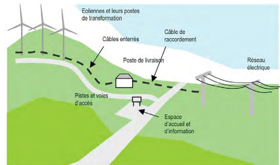
Figure 18 : Les composants d'un parc éolien 13
